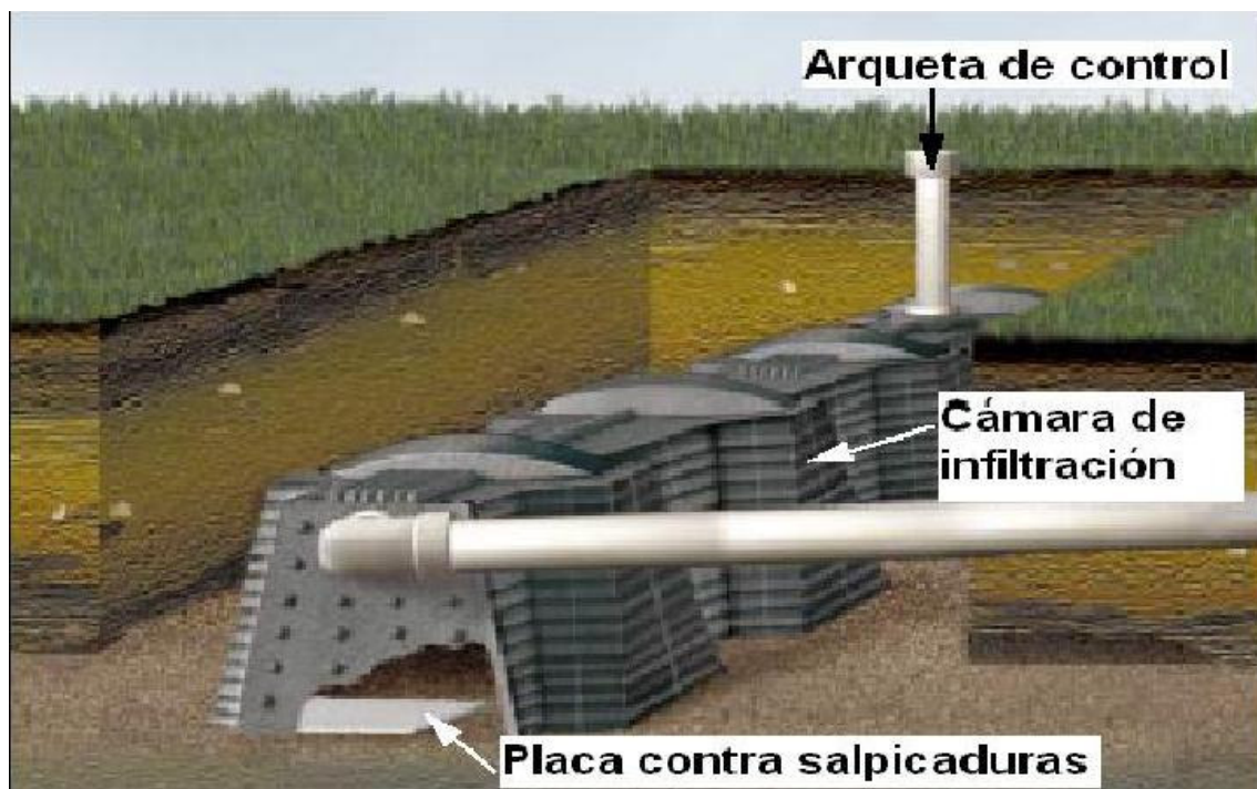
Figura 13. Perspectiva de un sistema de cámaras filtrantes (Lesikar et al., 2000).
