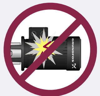
Fig. 1.4.6: Con motores ExnA sin chispas, no es probable que se produzca ignición. Consulte el texto en PDF
