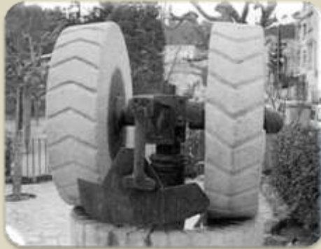
Muelas empleadas para desmenuzar el papel usado y reutilizarlo. Museo paplero de Capellades. Barcelona
