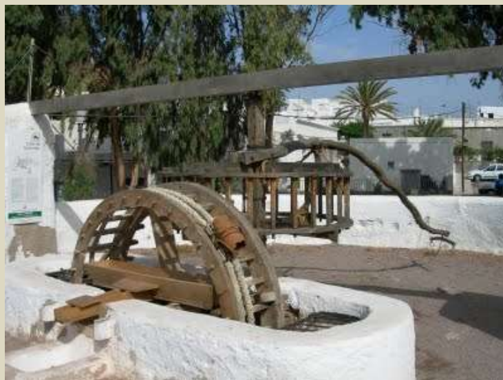
Noria de sangre pozo de los fráiles. Cabo de Gata. Almería
