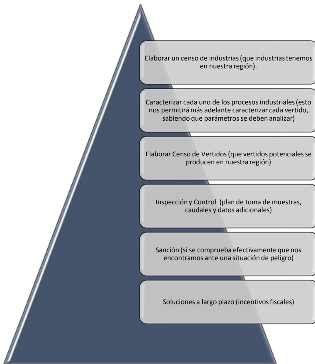
Figura 13: Fases iniciales en el diseño de un plan de gestión, inspección y control de vertidos al Sistema Integral de Saneamiento y a las EDAR urbanas en última instancia. Fuente: Elaboración propia.
