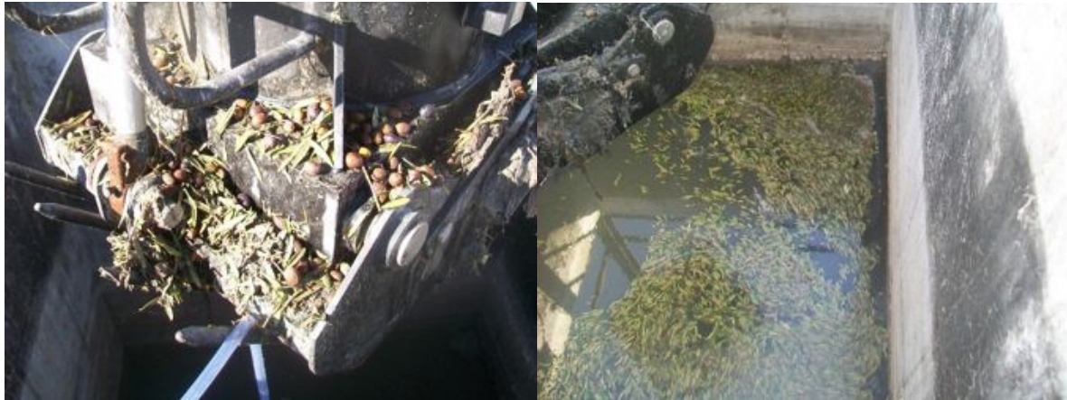
Imagen 7: Cuchara bivalva situada en el pozo de entrada de la EDAR de estudio 2, afectada por vertidos de dos Almazaras. Imagen propia.
