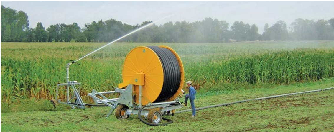
Ilustración 15. Cañón móvil arrastrado por enrollador automático de manguera, al final del ciclo de riego. En estos sistemas, el ciclo de riego se inicia al fondo de la parcela, donde se ven los árboles, desenrollando la manguera completamente. Posteriormente, el enrollador irá tirando del carro poco a poco hasta la posición que vemos en la foto. Fuente: Lindsay corporation.
