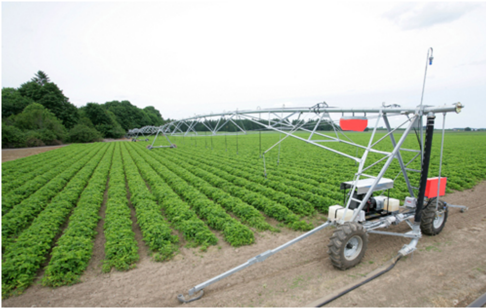
Ilustración 14. Lateral de avance frontal alimentado por manguera en un extremo y aspersores montados en bajantes. Fuente: Riegos Ruiz
