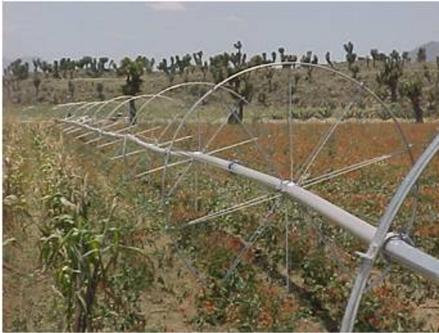
Ilustración 20. Tubería lateral con ruedas. Fuente: América equipos mecanizados
