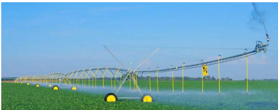
Ilustración 12. Sistema de pivote central con montaje de aspersores de pivote en bajante (tubos amarillos) y montaje de cañón aspersor en el extremo. Nótese que, debido a la longitud de la tubería lateral, ésta se encuentra sectorizada, apoyándose cada sector en una “torre” dotada de ruedas. Fuente: T-L Irrigation
