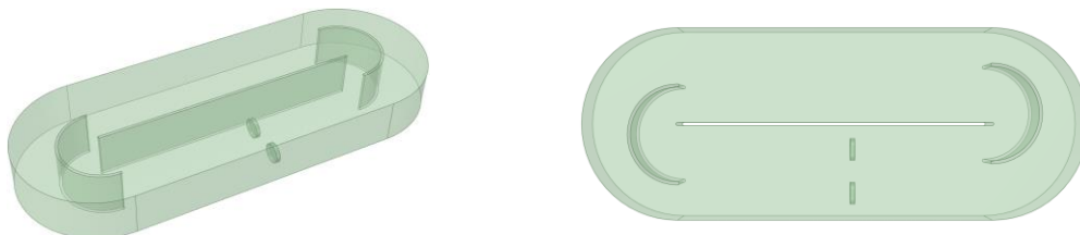
Figura 5: Modelo geométrico del reactor biológico completo.
