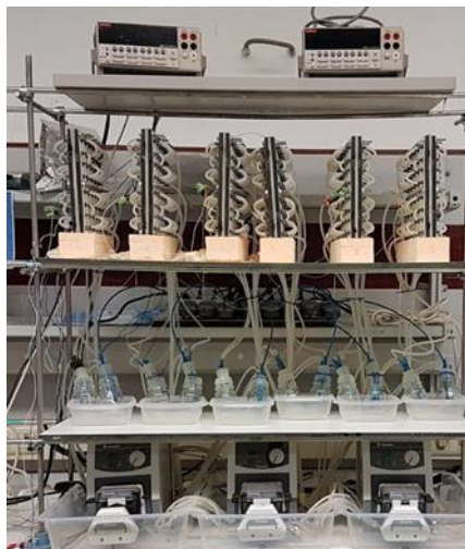
Figura 1. Stacks con 20 CCMs de doble compartimento
