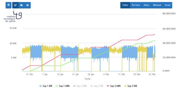
Figura 12: Monitorización en tiempo real de potencias y energía de soplantes regulados por estrangulamiento
