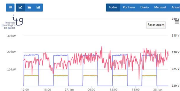
Figura 11: Monitorización en tiempo real de potencias y tensión de sistema de bombeo en EDAR tras sustitución por un sistema de mayor eficiencia.
