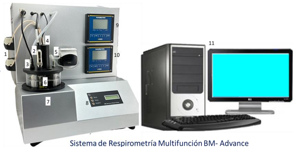
Figura 1. Sistema de Respirometría BM
