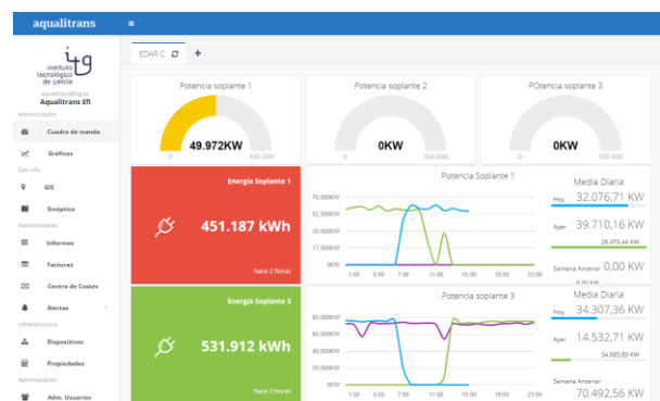
Figura 8: Cuadro de mando de herramienta de monitorización. Muestra parámetros de consumo energético de soplantes en EDAR.
