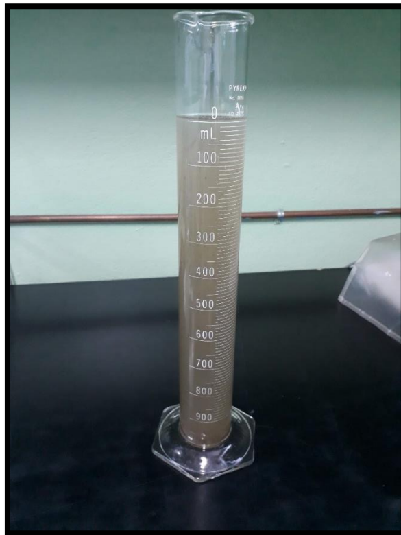
Figura 2. Muestra del lodo activado en la probeta para análisis macroscópico. Fuente Fotografía: Autor
