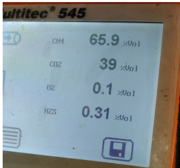
Medida de concentración de gases en biogás EDAR Víbora (Marbella).
