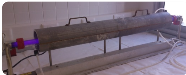
Figura 4. Reactor fotocatalítico con un fluorescente de luz BLB de 36W
