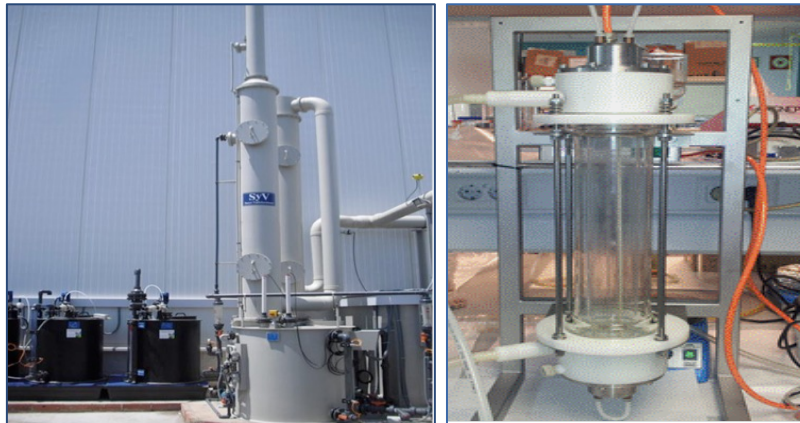
Figura 1. Izquierda: piloto de lavado químico de 1000 m 3 /día. Derecha: fotorreactor de fotocatalisis. EDARi Helados Alacant. Proyecto OLORES
