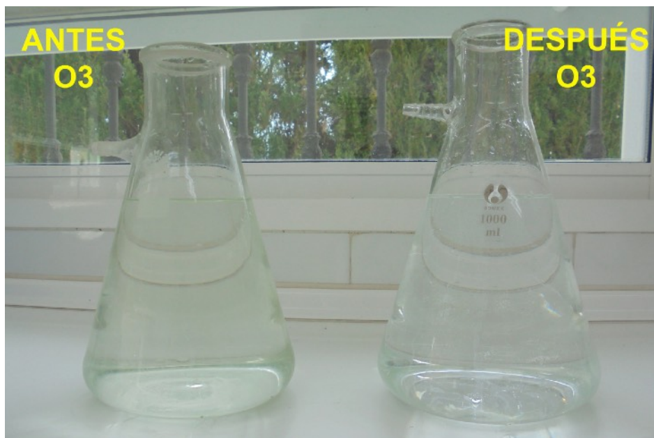
Foto-4: Efluente de la EDAR de Abanilla. A la izquierda agua procedente de los filtros de arena, previa al tratamiento con ozono. A la derecha agua de salida del tratamiento con O 3
