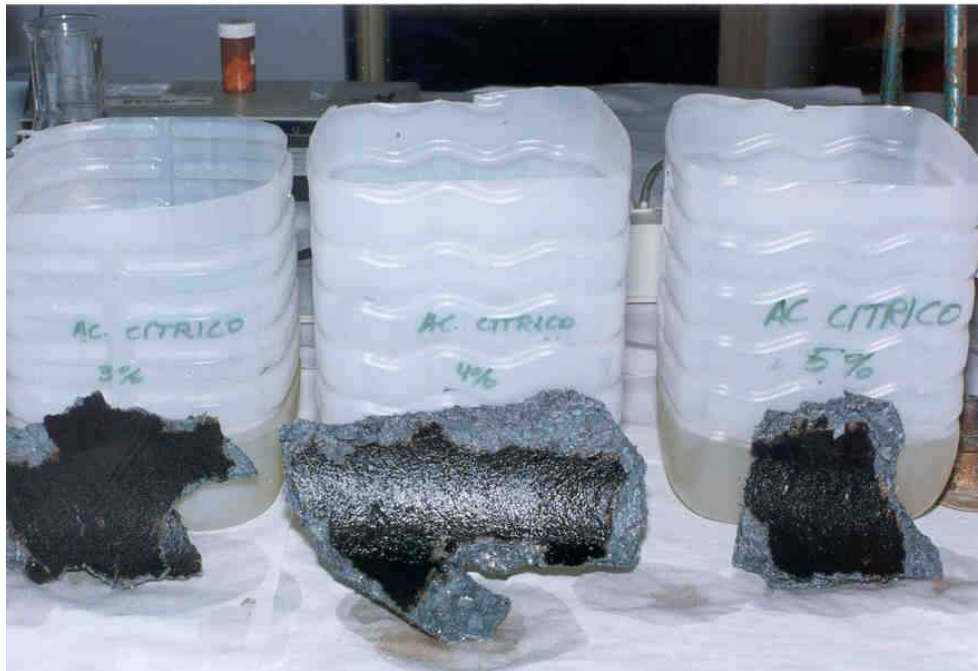
Foto 26. Estado inicial de las tuberías antes de los ensayos de eliminación de grasas (ácido cítrico 3, 4 y 5%)
