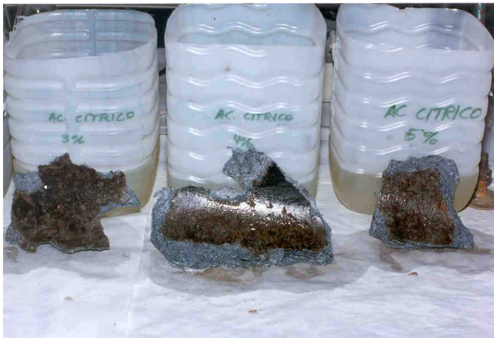
Foto 27. Estado final de las tuberías después de los ensayos de los ensayos de eliminación de grasas (ácido cítrico 3, 4 y 5%)
