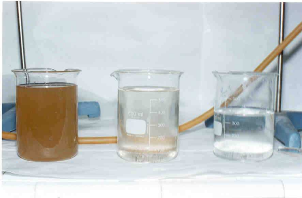
Foto5. Muestras del agua obtenida en cada una de las limpiezas. (Se observa como en la primera limpieza la cantidad de sólidos obtenidos es muy abundante, en cambio, en la última limpieza el agua sale prácticamente limpia).
