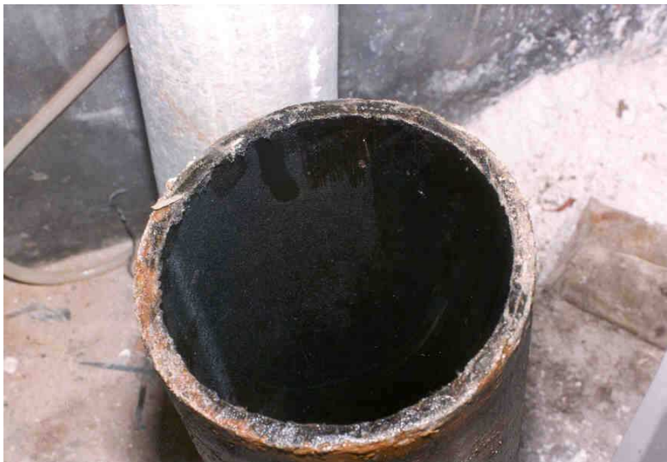
Foto 23. Muestra de un trozo de tubería en el que se observa la capa grasienta.
