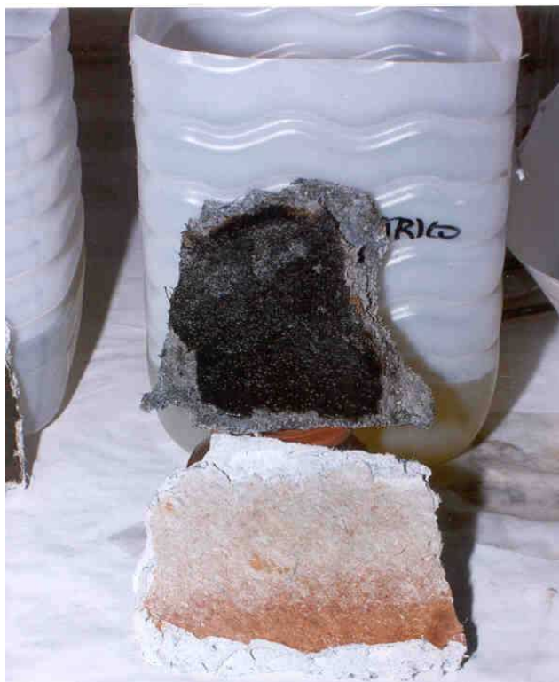
Foto 25. Ensayo con ácido cítrico. Se observa que se elimina por completo la capa de grasa de las tuberías.
