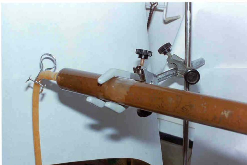
Foto2. Primera limpieza con H_2O_2 (se observa burbujeo y desprendimiento de fangos).
