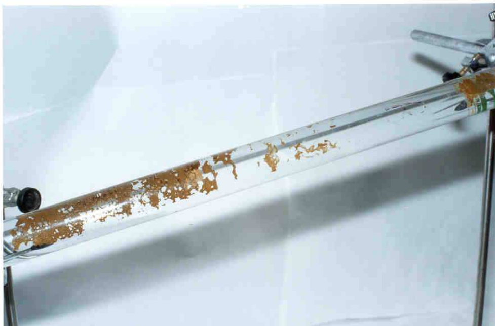
Foto4. Tercera limpieza con agua oxigenada. (Se ha producido prácticamente el desprendimiento de toda la capa de fangos.
