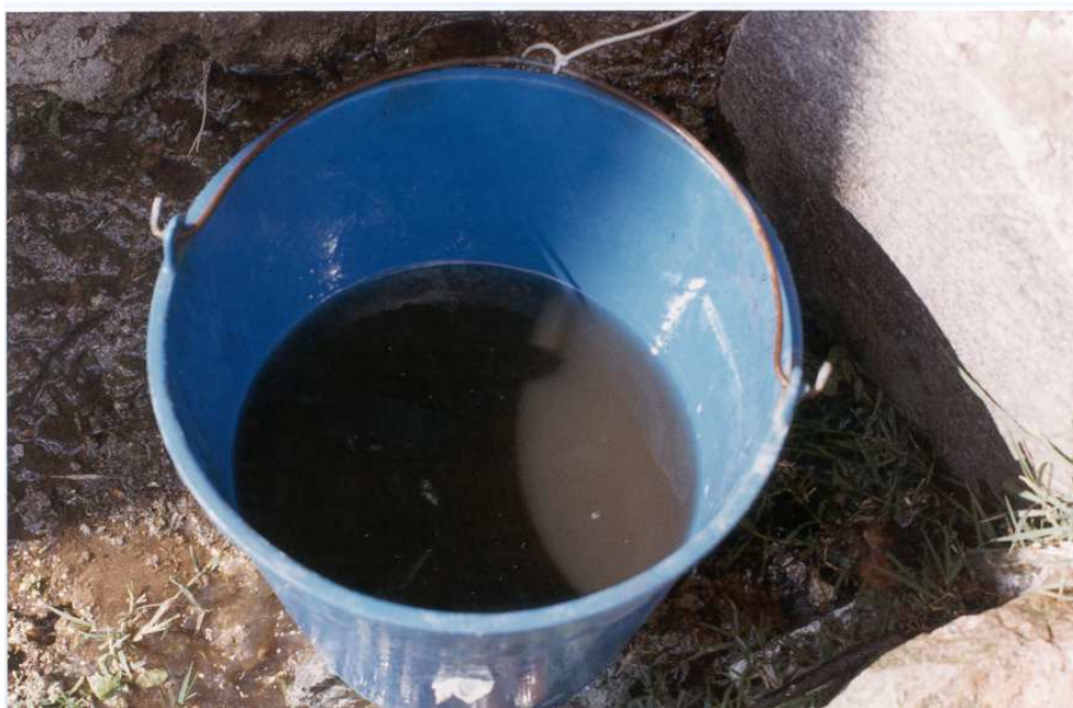
Foto 21. Salida del agua tras la primera limpieza. Se observa un agua bastante negruzca y con una gran cantidad de sólidos en suspensión.
