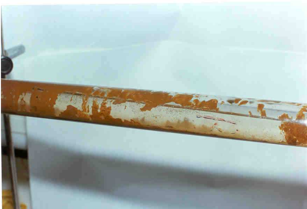
Foto3. Segunda limpieza con H_2O_2 (se observa el burbujeo al reaccionar el agua oxigenada ( H_2O_2 ), con la capa de sólidos lo que ocasiona un gran desprendimiento de sólidos en suspensión).
