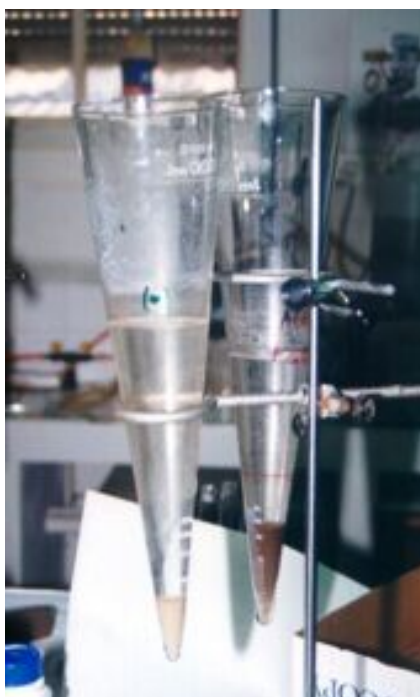
Foto 1: Ensayo decantabilidad en conos Imoff.
