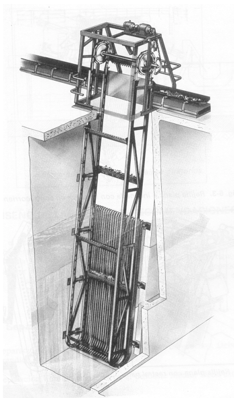
Fig. 1. Reja plana e inclinada con peines de limpieza movidas por cadena.
