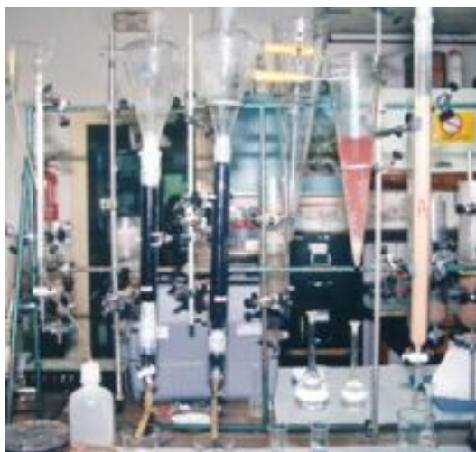
Foto 1: Ensayo en columnas de carbón activo y arcillas tratadas.
