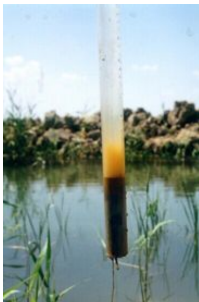
Foto 1: Muestreo de fango con barrena de metacrilato
