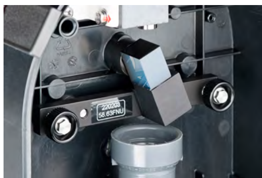
Montaje de la referencia sólida para re-calibración
