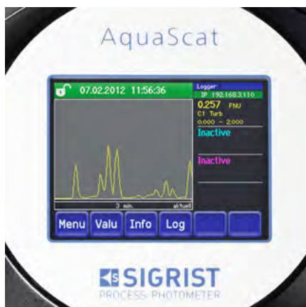
Unidad de control integrada con pantalla táctil a color
