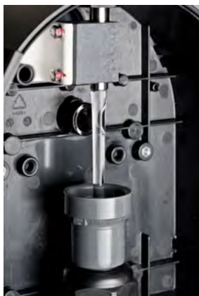
Medición sin contacto por principio de caída libre
