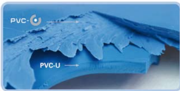
Típica estructura laminar del PVC-O
