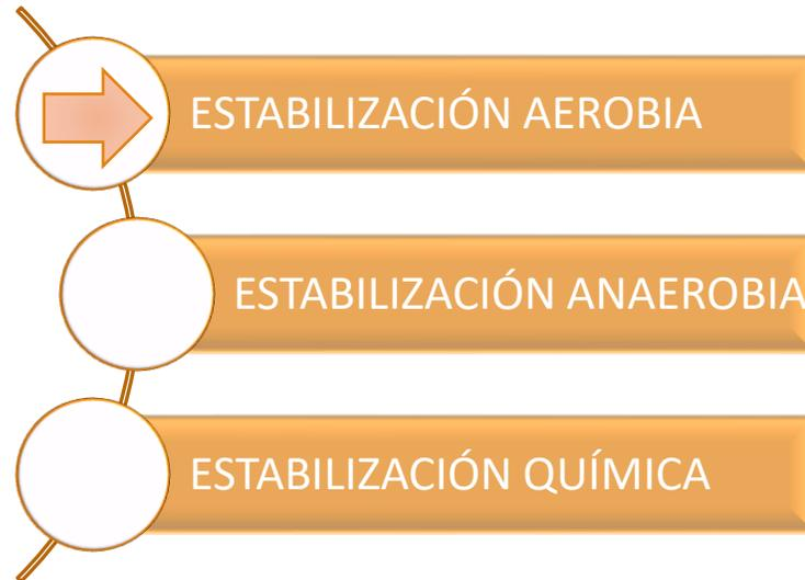
La estabilización aerobia consiste en la inyección de aire (oxígeno) en el interior del reactor. El proceso funciona en respiración endógena. Se produce una reducción de la materia volátil y por tanto de la materia seca.
