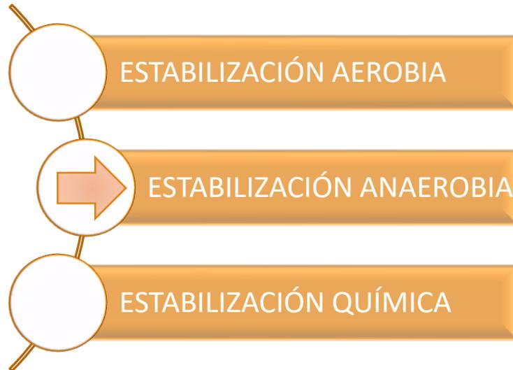
La estabilización anaerobia consiste en mantener condiciones anaerobias en los fangos y mediante diferentes fases (hidrólisis, acidogenosis, acetogenosis y metanogenesis) reducir la materia orgánica y obtener biogás con una proporción de metano (CH<sub>4</sub>) en torno al 70 %. Se produce una reducción de la materia volátil y, por consiguiente, de la materia seca producida por la EDAR.
