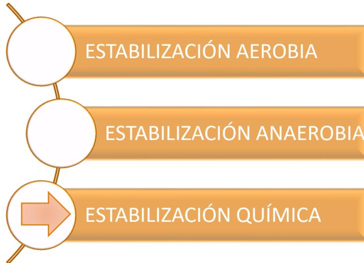
La estabilización química consiste en la adición de un producto químico (generalmente cal viva o apagada) para obtener un pH elevado e inertizar la materia orgánica. No se produce reducción de la materia volátil y se aumenta (en casi un 20 %) la materia seca producida en la EDAR.
