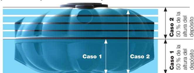
**Caso n°2 :** Si la capa freática se sitúa por encima de la mitad de la altura del depósito, **es necesario el anclaje del depósito a una base de cemento mediante eslingas.**
