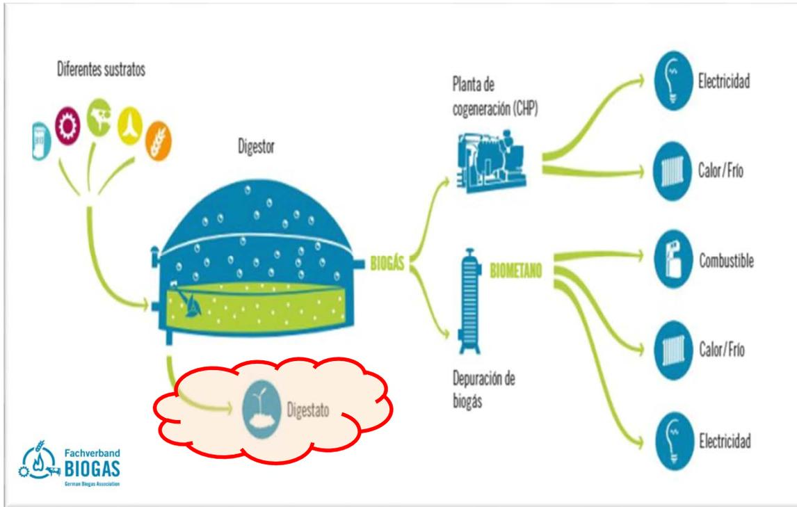
El **digestato** es el material residual digerido que se genera en un **proceso anaeróbico** utilizado para obtener energía a partir de un sustrato biodegradable.
