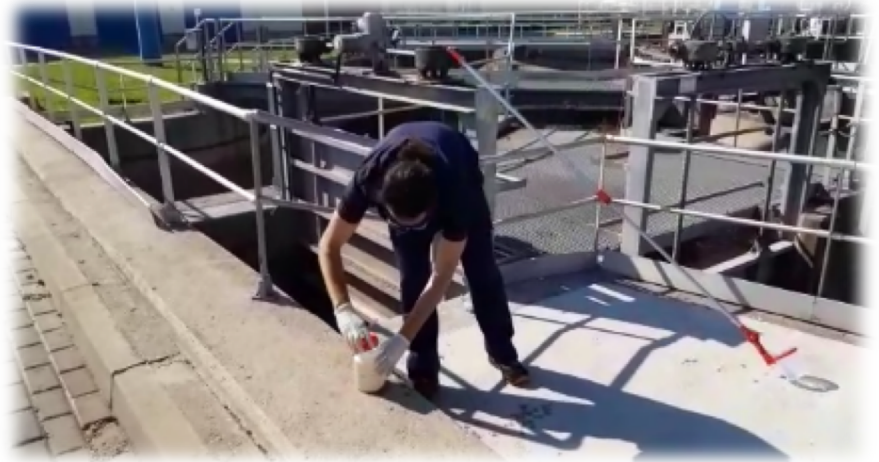
PREPARACIÓN DE MUESTRA EN BOTE PARA ENVIAR A LABORATORIO
