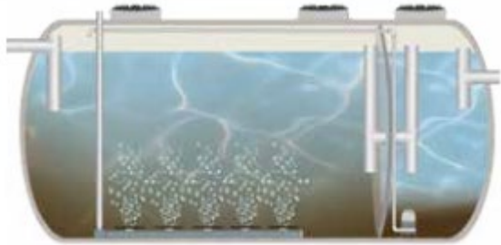
REACTOR BIOLÓGICO CLARIFICADOR
