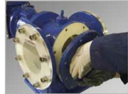
Se inspeccionan/reemplazan los cortadores, espaciadores y ejes
