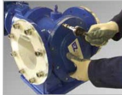
Se aflojan y retiran las contratuercas del eje
