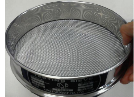
Tamiz para test (JIS Z 8801, ASTM E-11)
