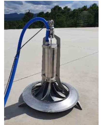
Agitador (depósitos de agua)
