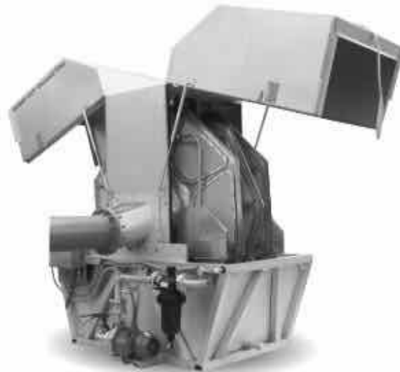
Filtro terciario (malla de inox)
