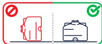
Los depósitos de superficie se deben instalar **SIEMPRE** sobre una superficie **rígida** (ej. una base cimentada o losa, dimensionada en función de la carga prevista), **nivelada**, y **libre de cualquier objeto extraño** (pequeñas piedras, tornillos, roscas, etc) que puedan agujerear el depósito.
