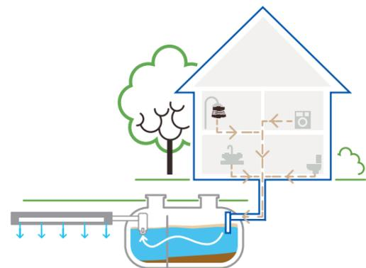
Las fosas Rewatec están fabricadas en PEAD 100% virgen mediante la técnica de rotomoldeo, lo que las hace ligeras, resistentes al paso del tiempo y a las agresiones químicas. Disponemos de modelos con certificación CE y rangos de volúmenes de 1.000 hasta 120.000 L.
