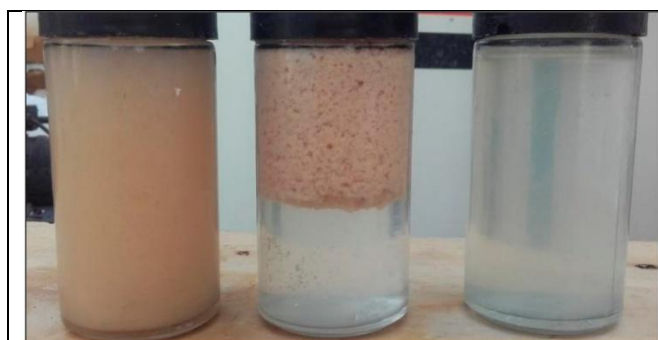
Afluente, lodo flotado del Sistema GEM, efluente del Sistema GEM.
