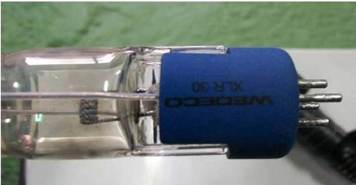
La emisión de luz UV depende de la concentración de átomos de mercurio, distinguiéndose dos tipos de lámparas en función de la presión de vapor de mercurio dentro de la lámpara, las de baja y las de media presión.
