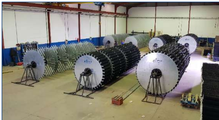
P.T.A.R PEÑAS ALTAS (Cuba) AÑO: 2018 – Suministro material completo, con 9 biodiscos. MDL: 230-600-3 y 420 m3 de biofiltros SYSTEM-P con carga en el tratamiento primario.
