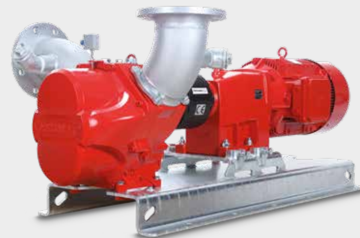
Bomba IQ152-158 montada sobre una bancada resistente a la torsión. Las conexiones orientables hacen que resulte muy fácil adaptar la bomba a las instalaciones más habituales.
