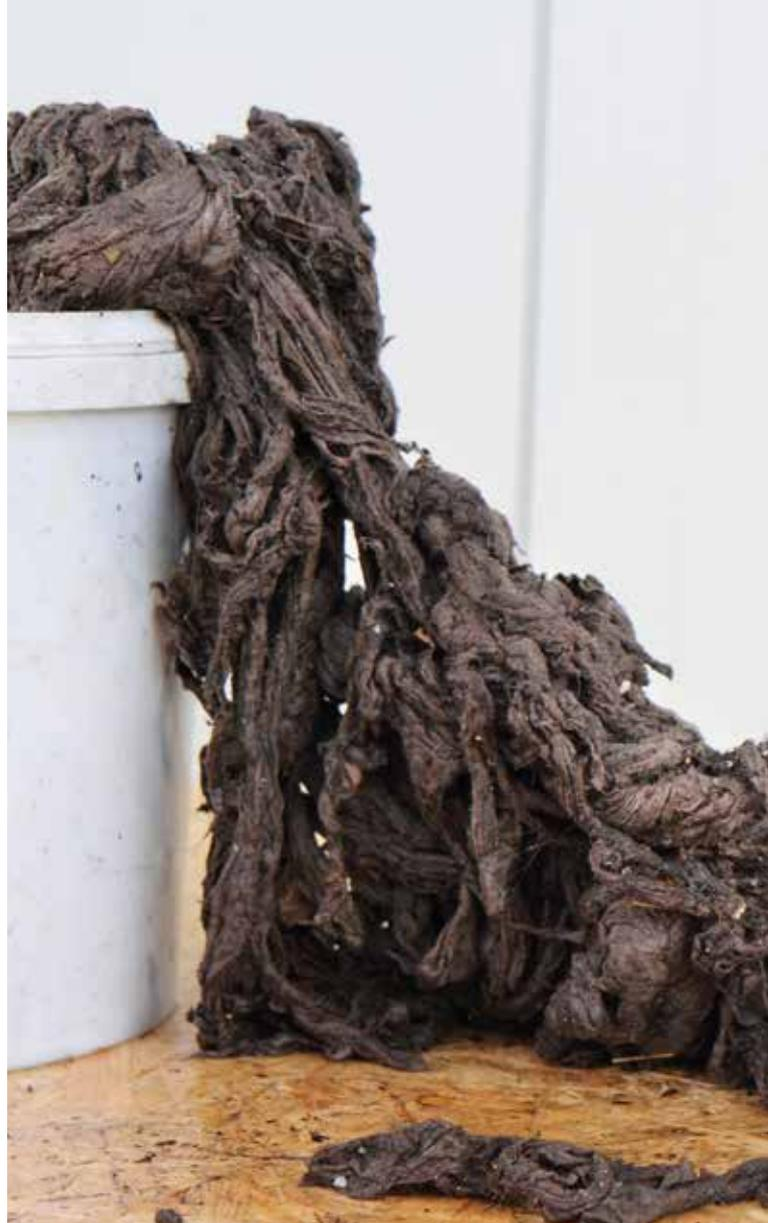
Los atascos de material por toallitas húmedas y fibras causan obstrucciones y problemas de funcionamiento.
